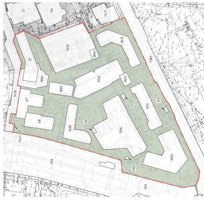
13. Схема границ существующих земельных участков и неразграниченных территорий в границах элемента планировочной структуры для объекта «Участка №3 микрорайона 10».
